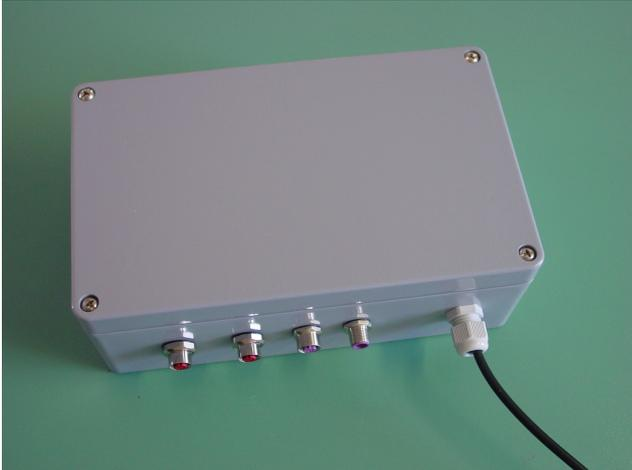
LED-Controller (Gehäuse IP66 260x160x80mm)
